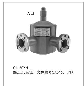
斯坡兰油位控制器可以直接栓接到压缩机曲轴箱，对于某些型号的压缩机，还可以通过一个可用的适配器连接曲轴箱，参见第6页。在安装一个油位控制器的过程中应小心，使压缩机处于水平状态，并且油位控制器压缩机固件和观察孔处于相同的高度。
