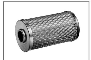
OF系列油过滤器安装在一个低压回油系统的油罐和油总管之间的油管线上。如果在这种系统上使用OF-303-BP，则应将其安装在油过滤器和油罐之间，以便有足够的压力降，能够在需要的情况下启用旁通（参见图1）。在一个高压回油系统中，油过滤器会安装在油分离器/油罐以及油总管之间（参见图2）。
