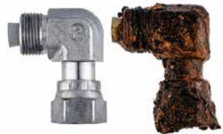
经过 3000 小时盐雾测试后的 ToughShield Plus (左) 和 锌扣压 (右) 旋转过渡接头
