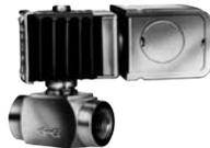
Utilice válvulas con diafragma de teflón para fluidos a alta temperatura o vapor por encima de 5 psig (107°C) sin superar los 10 psig (115°C). La **W3P1** es del tamaño ideal para utilizar en dispositivos de aire comprimido. Generalmente se necesita un cierre muy hermético para este tipo de aplicación. Esto se puede conseguir mediante la utilización de un asiento de neopreno en la **W3P1** en lugar del estándar de teflón. **Para ordenar indique RW3P1**
