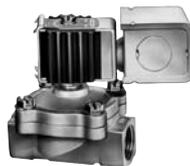
encima de 5 psig (107°C) sin superar los 10 psig (115°C). Las válvulas solenoides de diafragma cierran herméticamente en aplicaciones con diferenciales de presión normales. Para aplicaciones en las que existen diferenciales de presión menores que 5 psi en la posición cerrada, se recomienda usar una válvula con diafragma de Buna-N en lugar de teflón estándar.
