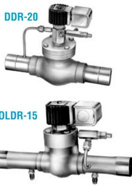
El **método de línea de descarga** consiste en instalar una válvula reguladora de presión diferencial en la línea de descarga antes del condensador. Para que ocurra el flujo inverso de gas caliente, la presión del gas de descarga (tubo principal de descarga) debe ser mayor que la presión del recipiente (tubo principal de líquido). Para esta aplicación Sporlan ofrece la válvula DDR-20.
