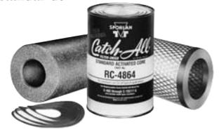
**RC-10098-HH** - Núcleo de carbón vegetal activado. Se usa en modelos C-30000 y C-40000. Este núcleo debe emplearse en sistemas con R-22, R-502 y R-407C en baja temperatura para eliminar la cera y para limpieza de sistemas que hayan tenido una quema de motor hermético.
