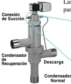
Las válvulas Sporlan para recuperación de calor son válvulas de tres vías con cierre hermético, diseñadas específicamente para desviar gas caliente del condensador normal hacia un condensador auxiliar.
