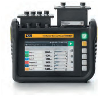
The Parker Service Master CONNECT SCM-600-xx mit Input Modul Analog SCMI-600-01 oder SCMI-600-03
