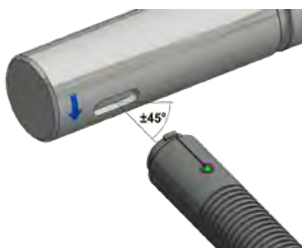
Rotierende Welle: Berührungslose Drehzahlmessung.
